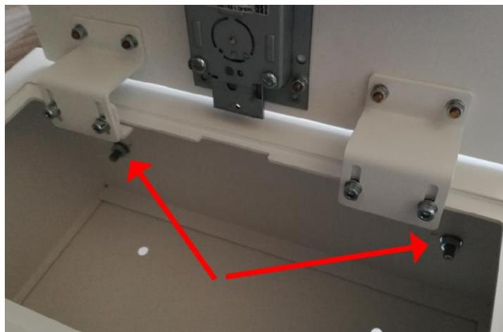
Lösen Sie für die Wandmontage die beiden Sechskantmutter und trennen Sie die beiden Teile voneinander.
