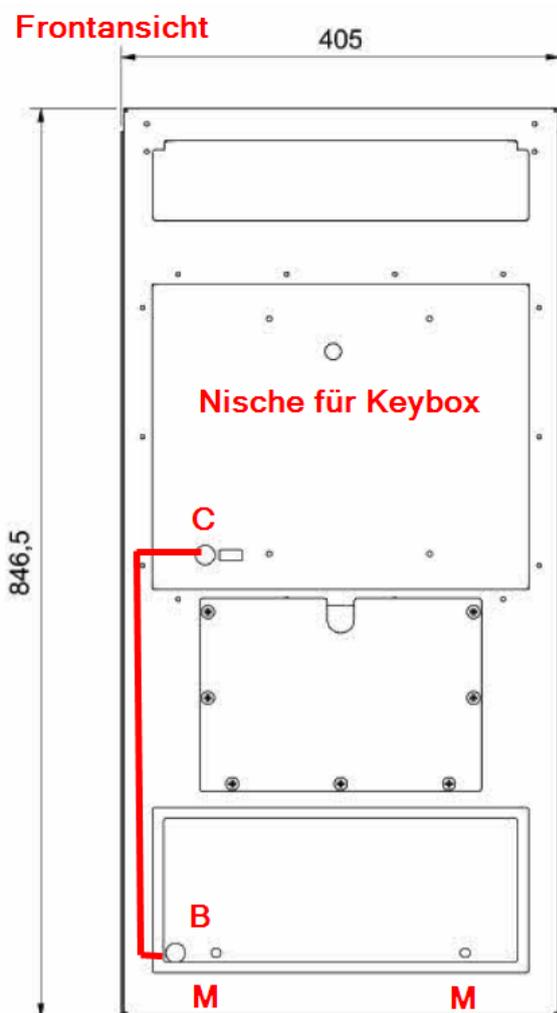
Führen Sie die **elektrische Zuleitung in ausreichender Überlänge** durch Bohrung B.
